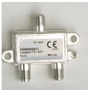
Miscelatori TV/SAT da interno completamente schermati con telaio in pressofusione di zama. Possono essere utilizzati anche come de-miscelatori TV/SAT invertendo ingressi con le uscite. Compatibili con i segnali digitali DTT con modulazione COFDM
